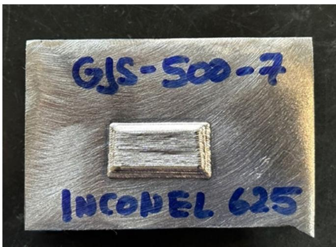
◀ Bild 4. Arbeitsprobe mit dreilagiger Impuls-Laserstrahl-Auftragschweißung
