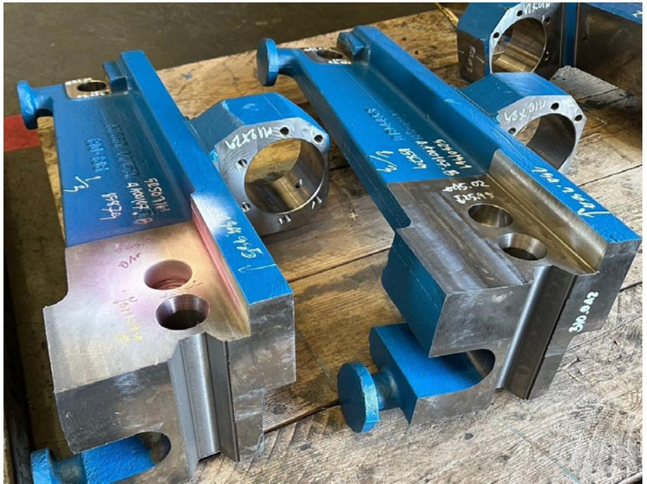
▲ Bild 2. Aus Gusseisen, Typ GJS-400-15 (EN 1563), bestehende Maschinenbauteile, die durch örtliche Auftragschweißungen repariert werden sollten
