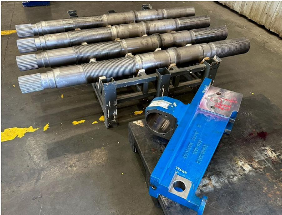
▲ Bild 1. Aus Gusseisen, Typ GJS-400-15 (EN 1563), bestehende Maschinenbauteile, die durch örtliche Auftragschweißungen repariert werden sollten
